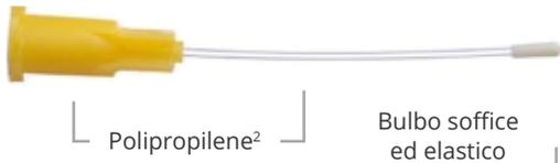
L'intero sondino è realizzato in polipropilene, lo stesso materiale usato per la costruzione delle siringhe in plastica. Il bulbo soffice riduce notevolmente il rischio di introduzione in trachea o perforazione dell'esofago. Disponibili in 14 misure per roditori, dai topi, ai ratti, sino al coniglio.
