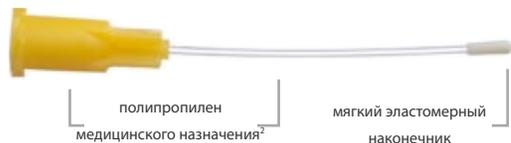
Трубка и коннектор типа Луер изготовлены из того же материала, что и используется для производства пластиковых шприцов. Мягкий грушевидный наконечник трубки служит для уменьшения риска её случайного попадания в трахею и перфорации пищевода. Трубки доступны в 11 размерах для различных грызунов: от детёнышей мышей и крыс до кроликов.
